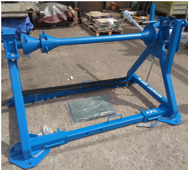
Stojan na lanové cívky - U. S. Steel Košice, s.r.o.
